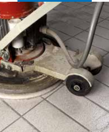
Czyszczenie na mokro przy użyciu maszyny do mycia podłóg z obrotową tarczą z filcu typu Scotch-Brite®
